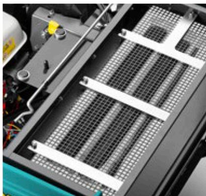
Con una estructura innovadora, grande superficie de filtrado y una eficiencia de filtrado de hasta 99,9%, el Multipocket® Filter entrega aire limpio de vuelta al entorno y garantiza una capacidad de filtrado duradero. El filtro además es lavable, resistente al agua y aceite, autolimpiante y fácil de mantener.
